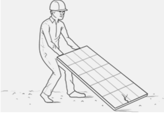
არასწორმა ტრანსპორტირებამ ან დამონტაჟებამ შეიძლება დააზიანოს მოდული
